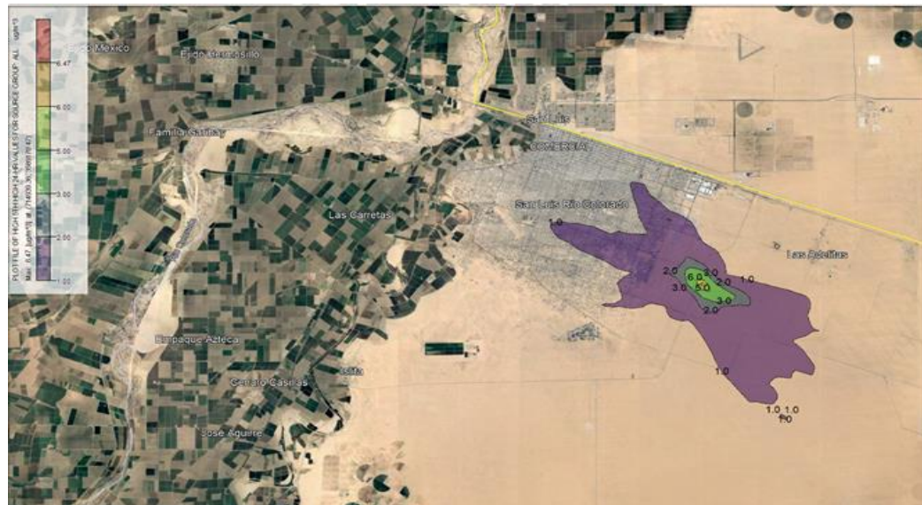
Figura 8. Curvas de isoconcentración del SO 2 por la operación de 22 unidades motogeneradoras a 24 horas
