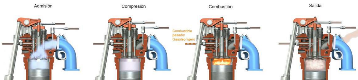
Figura 2.30 El proceso de combustión durante el funcionamiento con combustible de respaldo
